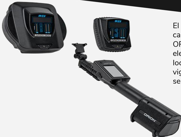
El detector de juntas no lineares ORION™ HX Deluxe (NLJD) tiene dos cabezales de antenas intercambiables de 2.4GHz y 900 MHz. El ORION™ HX Deluxe se utiliza para localizar semiconductores electrónicos. De esta manera, el ORION™ HX Deluxe NLJD detecta y localiza dispositivos electrónicos ocultos cableados o dispositivos de vigilancia (cámaras o transmisores) aunque estén apagados. También servirá para localizar micrófonos y cámaras ocultas cableadas.
